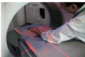
撮影範囲をレーザー光で示す“エアファインダ機能”
