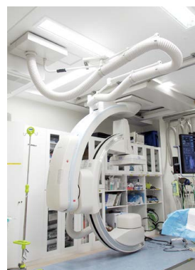
Cアームは天井懸垂式で未使用時には待避でき、さまざまな人的配置や機材の移動に対応できる。
