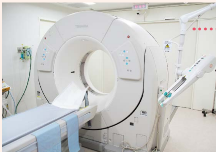
CT室の80列の「Aquilion PRIME」 ガントリ裏面の操作パネルから寝台操作ができる。
