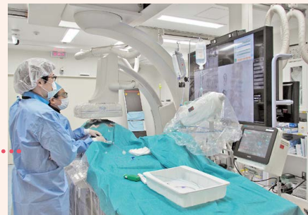
血管撮影装置「Infinix Celeve-i」 大画面モニターで透視、CT画像、生体情報など必要な情報が確認できる。
