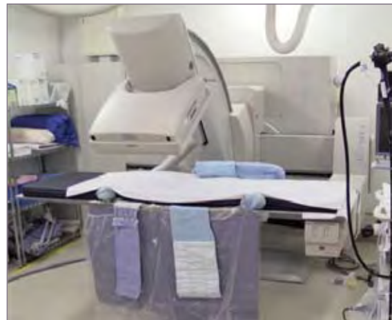
図6 CアームX線TVシステムUltimax-i Cアームの回転はレバー操作により容易に行える。
