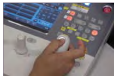
図6 CアームX線TVシステムUltimax-i Cアームの回転はレバー操作により容易に行える。
